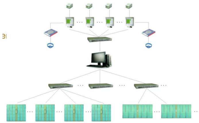
**Одна система:** Одна единственная административная консоль может управлять сотнями модулями хранения, обеспечивая дистанционный контроль и мониторинг.
